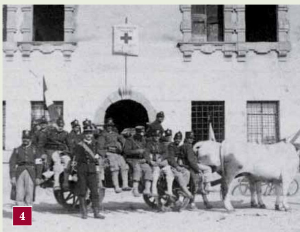
1 Con il termine " carretta da battaglione leggera " veniva identificato il mezzo di trasporto, a due ruote e a trazione animale, in dotazione all'artiglieria di montagna - ma non solo - in servizio, con leggere modifiche, dalla seconda metà dell'800 fino alla fine degli anni '50
